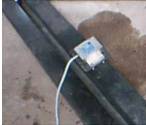
Fotografía 3.4: Acelerómetro 17 instalado en la base del prototipo
