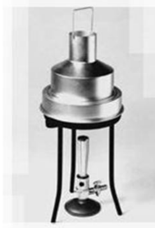
Figura 48. Equipo manual para determinar el residuo carbonoso Conradson Marca: Petrotest
