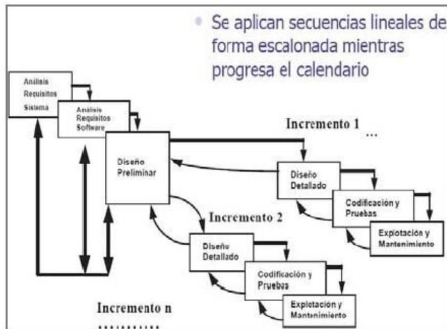
En la siguiente figura se puede visualizar una representación generalizada y simplificada de las fases o etapas del modelo de desarrollo iterativo o incremental.
