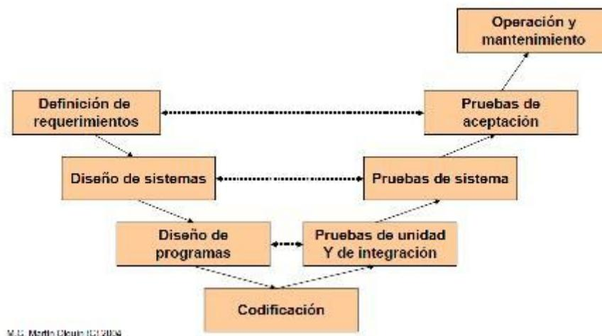
La parte izquierda de la “V” representa la corriente donde se definen las especificaciones del sistema. La parte derecha de la “V” representa la corriente donde se comprueba el sistema (con base en las especificaciones definidas en la parte izquierda). La parte de abajo, donde convergen ambas corrientes, representa la fase de desarrollo.
