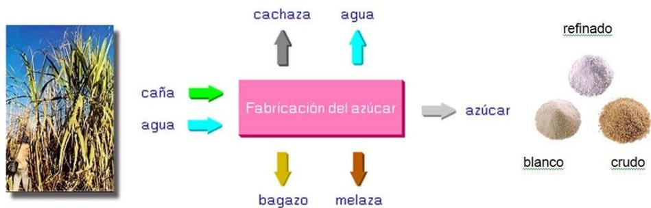
**Figura 5. Proceso de fabricación de azúcar**
