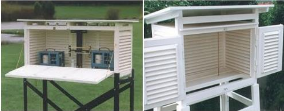
Figura 7. Abrigo Meteorológico, donde se alojan instrumental de medición de Temperatura y Humedad.
