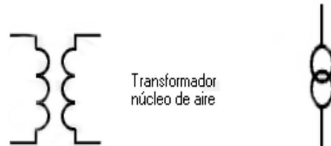
Figura 14: TRANSFORMADOR NÚCLEO DE AIRE
