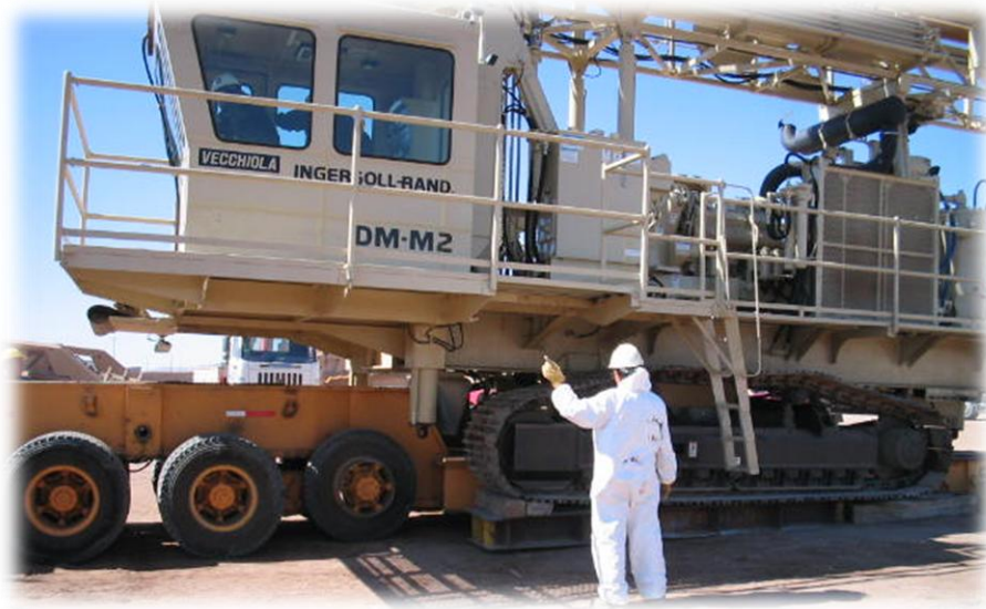
Figura 18. Perforadora DMM2. Barandas y escaleras
