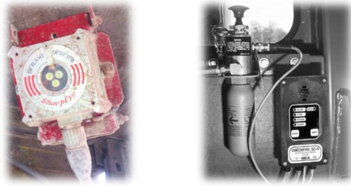
Figura 56. Izda: Sensor de llama – Dcha: Módulo de control, actuador manual/eléctrico, botella de 1oz de N 2
