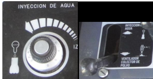
Figura 53. Indicadores de cabina y control (agua de barrido)
