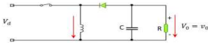
Figura 36 Convertidor reductor - elevador
